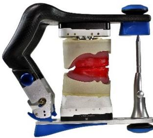
Artikulator wird umgedreht Arh entfernt Unterkiefer Modell in die Bisschablone eingesetzt und befestigt.
